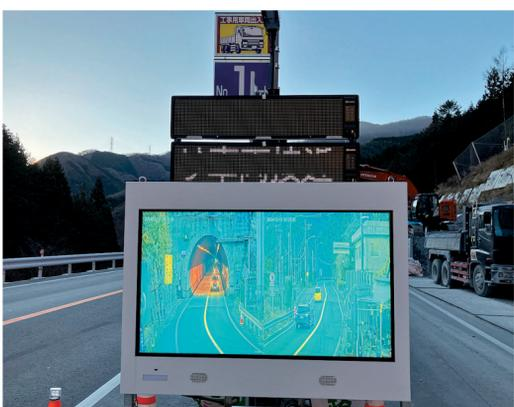
現場出入口付近に設置した「AI搭載型カメラ自動判別警報器」のモニター画面
