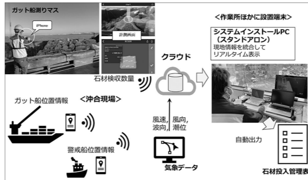
海上工事デジタルツインシステム概念図
