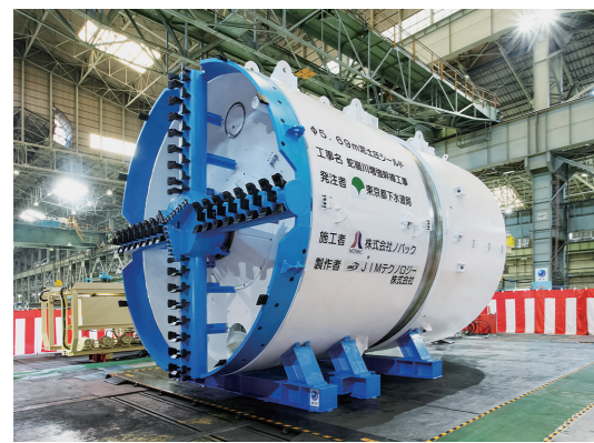
シールドマシン(マシン外径5.69m)
