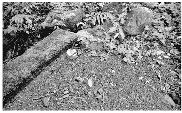
豪雨による機器損傷(上:土砂に埋まった水位計 下:排砂後の状況)
