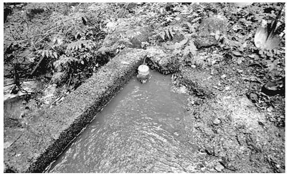
豪雨による機器損傷(上:土砂に埋まった水位計 下:排砂後の状況)
