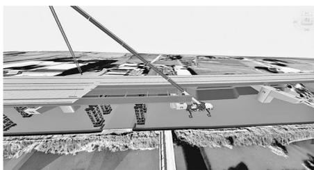
狭隘なヤードにおけるBIM/CIMを用いた施工検討
